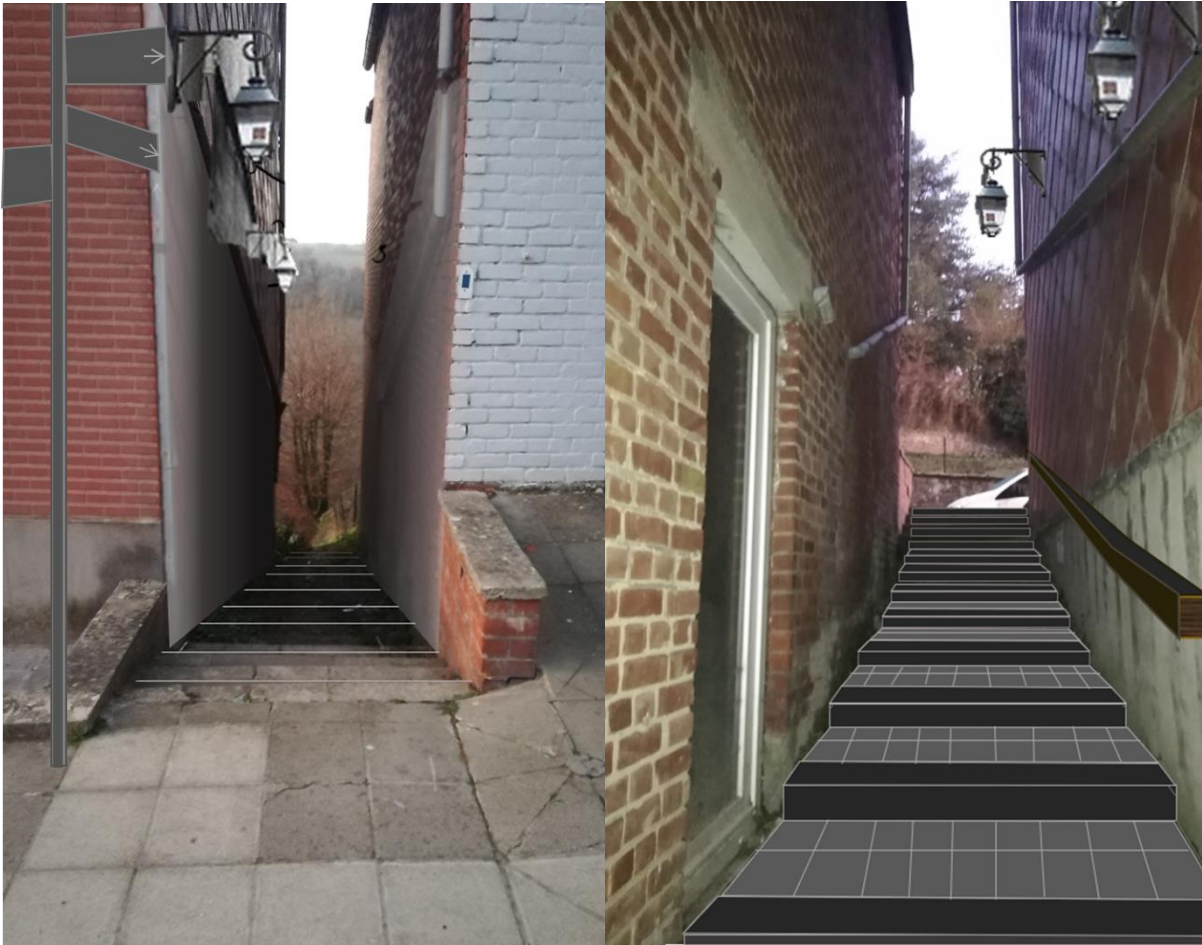
Figure 2 : Aménagement du passage entre les maisons : escalier minéral (pavés et pierre bleue), lampadaires suspendus, rampe, panneau fléché utilitaire à l'entrée du passage
