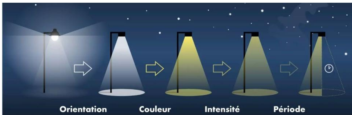
Figure 3 : Quatre principes pour un éclairage plus respectueux de l'environnement (Réserve internationale de ciel étoilé de Mont Mégantic).
