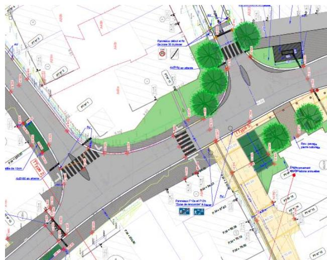
5- « Au niveau du stationnement dans la rue Laloux, la largeur de 1,80m est insuffisante. La largeur minimum pour le stationnement est de 2m. Il convient de marquer la différence entre le stationnement et le trottoir en rehaussant les trottoirs pour éviter le squat par des véhicules. »
